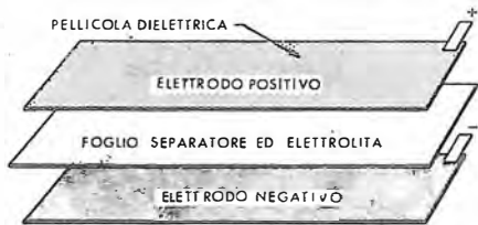
Fig. 38 N - Nei condensatori elettrolitici a secco, l'elettrolita è trattenuto da una garza o da una carta posta tra i due elettrodi così come abbiamo visto già in figura 37 N. Il dielettrico è la sottile pellicola di ossido formata sull'elettrodo positivo.
