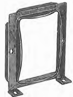
Fig. 47 Q - Tipico serrapacco per montaggio verticale. La nervatura lo rende particolarmente robusto: va accoppiato ad altro elemento eguale.
