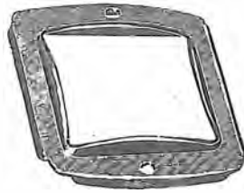
Fig. 48 Q - Serrapacco per montaggio orizzontale. Spesso ne viene usato uno solo in quanto il trasformatore appoggia, dall'altro lato, sulla lamiera del telaio.
