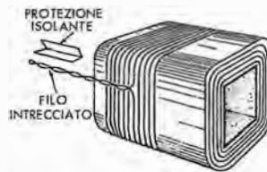
Fig. 44 Q - Per riportare all'esterno (o a pagliette di ancoraggio) i fili di collegamento, se si tratta di una presa, come illustrato, si attorcigliano i due capi e si ha cura di isolarli trasversalmente rispetto agli altri fili, con protezione isolante.
