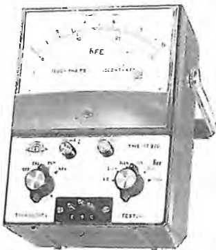
Fig. 72 T - Questo Provatransistori consente numerose misure e soddisfa perciò quasi tutte le esigenze del tecnico radioriparatore. Si può misurare il « beta » e l'« alfa » tanto di tipi per Alta Frequenza quanto di modelli di potenza B.F., sino a 150 W. È alimentato internamente con pile.
