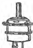
Fig. 37 R - Triodo costruito con metallo e ceramica. Se la valvola è destinata all'impiego su frequenze molto alte le distanze interelettrodiche devono essere ridotte al minimo: i reofori devono presentare induttanza molto bassa. Tutto ciò si può ottenere con una costruzione del genere ove, in sezione, si osserva; E = contatti per il filamento; F = griglia; G = anello griglia; H = catodo; A = placca.
