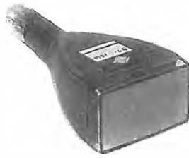
Fig. 63 M - I tubi a schermo rettangolare sostituiscono sempre più, anche negli oscillografi, i tubi rotondi.
