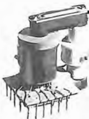
Fig. 55 M - Tipica esecuzione di induttanze formanti un autotrasformatore (spesso anche un trasformatore) funzionanti su 15 625 Hz nei ricevitori TV. È anche un corrente impiego delle « ferriti » viste a figura 27 M.
