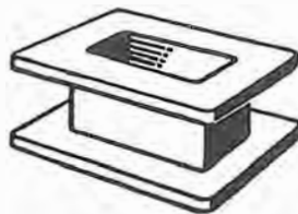
Fig. 41 Q - A volte, nei trasformatori costruiti da fabbriche specializzate, per i tipi di maggiore impegno vengono adottate carcasse particolarmente robuste e sicure, realizzate in materiale plastico, rigido, stampato. Praticando sulle fiancate di dette carcasse una serie preventiva di fori si agevola l'uscita dei diversi conduttori dell'avvolgimento.
