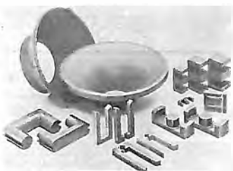
Fig. 27 M - Per i nuclei di avvolgimenti funzionanti con frequenza oltre i 10 000 Hz si adottano — onde evitare le perdite Foucault — le « ferriti », materiali ad alta permeabilità. Un vasto impiego di questi nuclei si ha in diversi componenti per televisione, funzionanti a 15 000 Hz circa.
