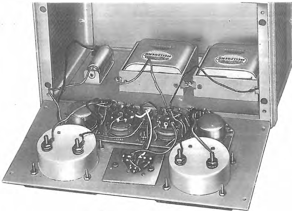
Fig. 83 T - L'insieme del pannello frontale analizzato nel disegno a pagina 25 t è qui fotografato prima del fissaggio, finito, innanzi alla custodia-cassetta nella quale si scorgono le diverse batterie (1,5 volt, a sinistra, e due da 4,5 V da collegare in serie, a destra). L'insieme del materiale pronto per il montaggio è contraddistinto dalla sigla UK 560/S nella serie Amtron.
