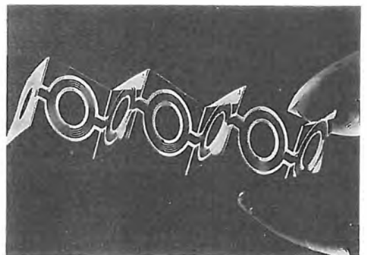
Fig. 47 M - Secondo questa tecnica le bobine stampate sono ricavate da entrambi i lati di un supporto flessibile in poliestere; esse sono intercollegate, ed il supporto viene piegato interponendo un foglio di isolamento tra le pieghe. A parità di induttanza risultano più piccole e più compatte di quelle a filo avvolto.
