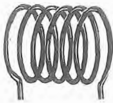
Fig. 28 M - Tipo di induttanza a solenoide, per onde corte. È caratterizzato da minima perdita in quanto il conduttore è avvolto « in aria »; a volte viene saldato direttamente ai componenti ai quali deve essere collegato.
