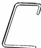
Fig. 33 M - Un semplice conduttore può rappresentare già l'induttanza necessaria al circuito allorché si agisce sulle frequenze molto alte (ordine delle centinaia di MHz); in questi casi è quasi sempre un filo argentato.
