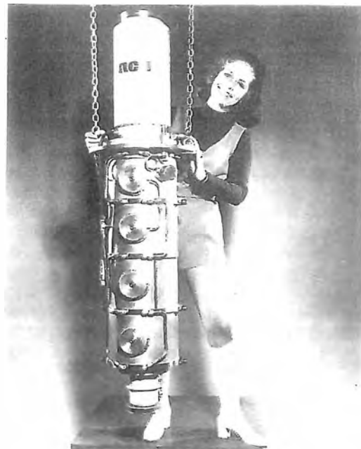
Fig. 39 R - Quest'altra valvola è alta 1,5 m e pesa oltre 90 kg. È costruita per trasmettitori TV nel quale impiego, in gamma UHF, può avviare all'antenna circa 31 chilowatt a radiofrequenza.
