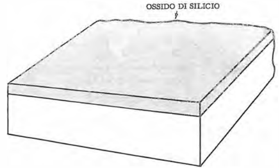
Fig. 36 T - Quanto abbiamo sin qui esposto può essere meglio compreso se osserviamo la piastrina in un disegno prospettico. All'inizio l'ossido di silicio occupa tutta la superficie della piastrina (chip).
