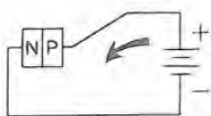
Fig. 1 T - Applicando ad una giunzione una tensione con polarità positiva alla regione P (negativa in N) si ha passaggio di corrente (elettroni: corrente diretta).
