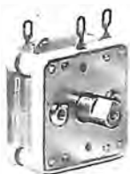
Fig. 57 N - Nei ricevitori più economici si impiegano condensatori variabili che adottano un dielettrico plastico: ciò riduce le dimensioni ed i costi senza compromettere molto i risultati, specialmente per la ricezione delle onde lunghe e medie.
