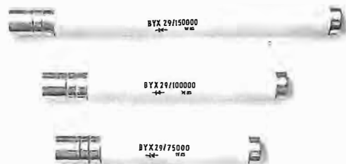
Fig. 35 S - Raddrizzatori per tensioni molto alte e deboli correnti; sono costituiti da diodi a giunzione posti in serie. Gli impieghi più comuni di queste cartucce si verificano nel campo delle apparecchiature per raggi X e microscopia elettronica.
