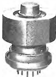
Fig. 40 R - Triodo di struttura planare: il dissipatore anodico in ossido di berillio, va applicato a radiatori di grande superficie. In figura si vede anche un amplificatore da 1 kW per onde decametriche con due di queste valvole. Si noti il dissipatore di calore, alettato, applicato alla parete posteriore.
