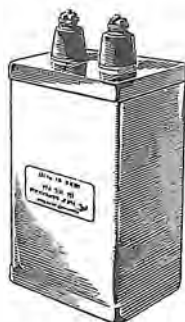
Fig. 27 N - Condensatori in olio in custodia metallica a chiusura stagna. Molte volte l'olio non è il dielettrico ma solo un elemento di sicurezza.
